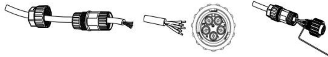
2. เสียบเทอร์มินัลทริกของสายนำกระแสไฟฟ้าทุกๆ 3 เส้นเข้าไปในรูของปลั๊กตัวผู้ จากนั้นขันสกรูแล้วตัวให้แน่น
